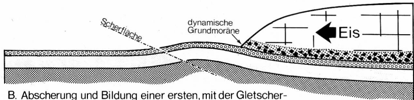
B. Abscherung und Bildung einer ersten, mit der Gletscherbasis verbundenen Scholle (Primärscholle)
